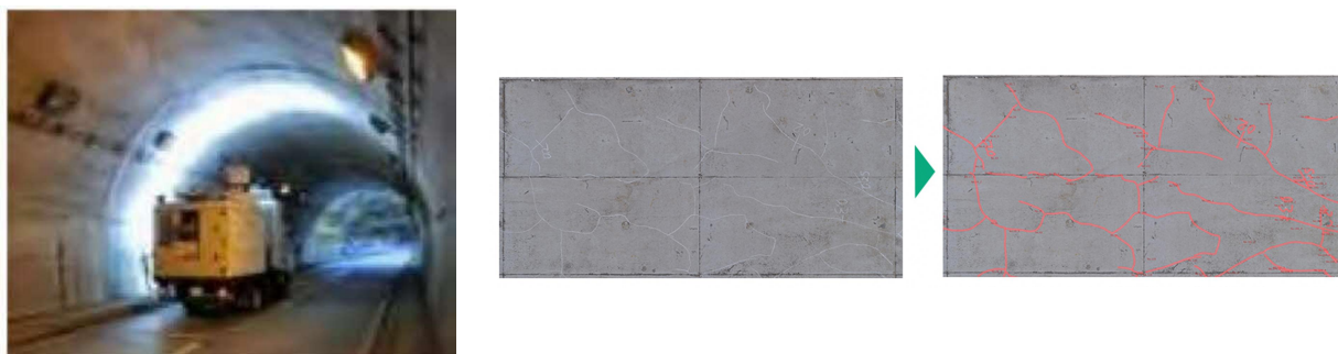
図7.8 定期点検・詳細調査での新技術イメージ（左：画像計測技術、右：画像診断技術）
