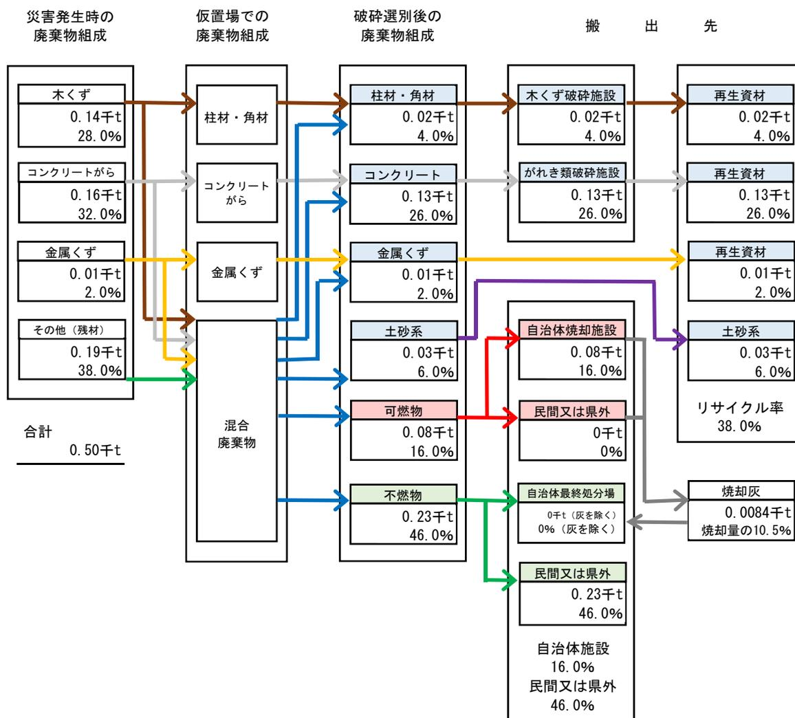
図 1 2 雨滝-釜戸断層地震における災害廃棄物処理フロー
