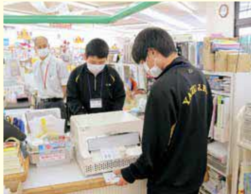
本を透明フィルムに入れ、熱を与えて収縮させる専用の機械を通すと包装が完了
