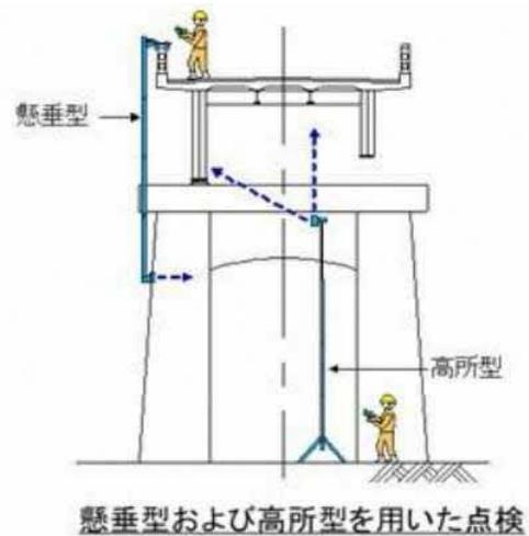
「橋梁等構造物の点検ロボットカメラ」【BR010019-V0221】
