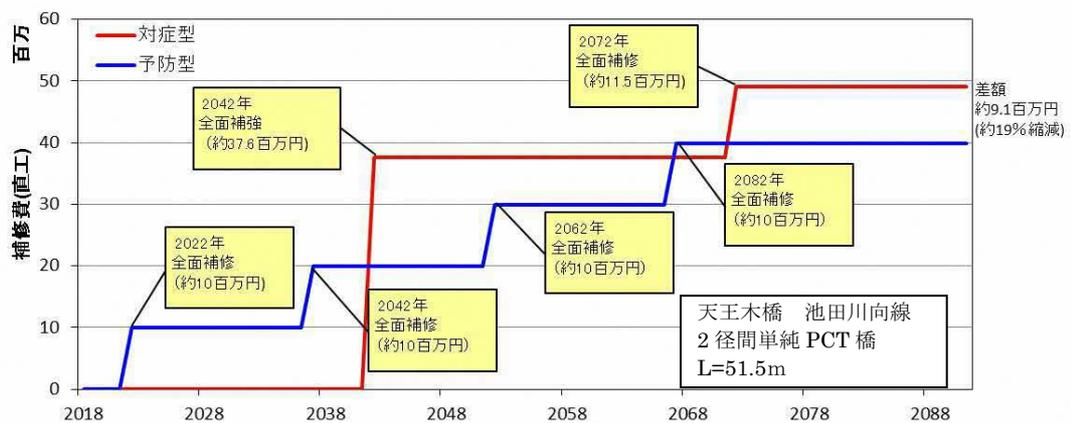
図 7 補修調査・設計に基づく補修費, 架替費推定例
