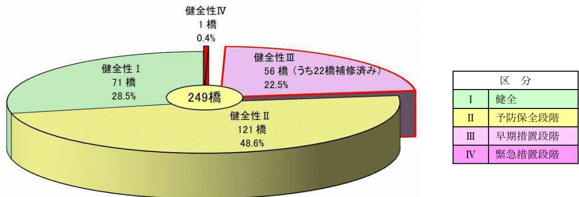
図4 定期点検による健全度評価の結果
