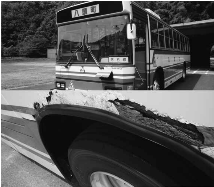
▲ 更新前のスクールバス(下段写真:腐食部分)
