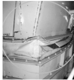
爆発で変形した振動コンベア
