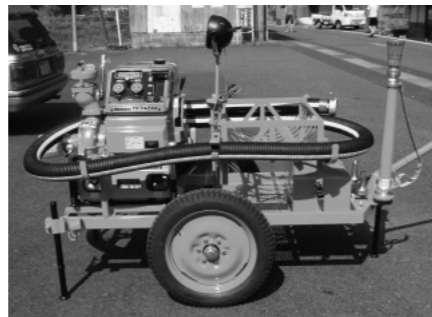
落岩自警団に導入された可搬消防ポンプ
