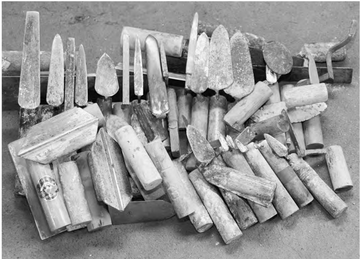
▲上田さんが長年愛用している鏝。50丁以上の中から目的に応じて使う。使いやすいように自分で加工した鏝もある。
