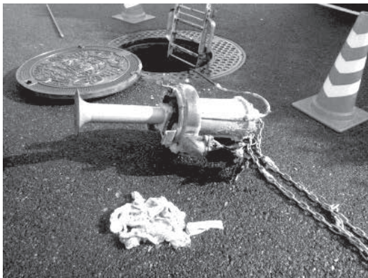
マンホールポンプに詰まっていたウェットティッシュの塊り
