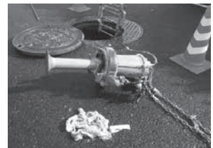
マンホールポンプに詰まっていたウェットティッシュの塊り
