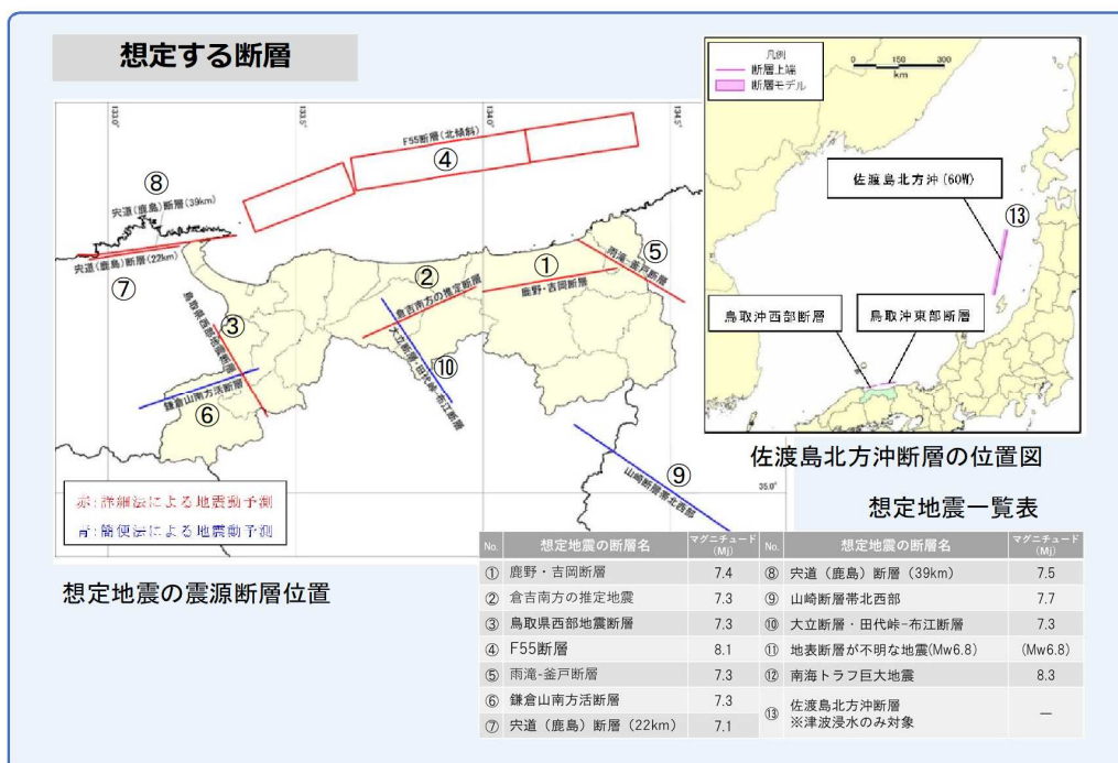
図-11 「鳥取県地震防災調査研究委員会」が設定する地震断層 （出典：鳥取県国土強靱化地域計画（2018 改定版））
